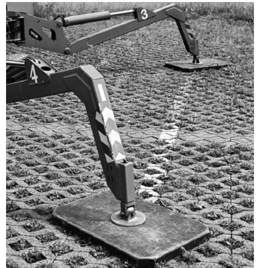
2 Hubarbeitsbühnen mit Stützen müssen auf unbefestigten Böden auf Unterlegplatten abgestützt werden.
