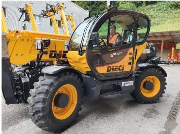
Die Allradlenkung ermöglicht einen kleinen Wenderadius für schnelle Arbeitsabläufe.
