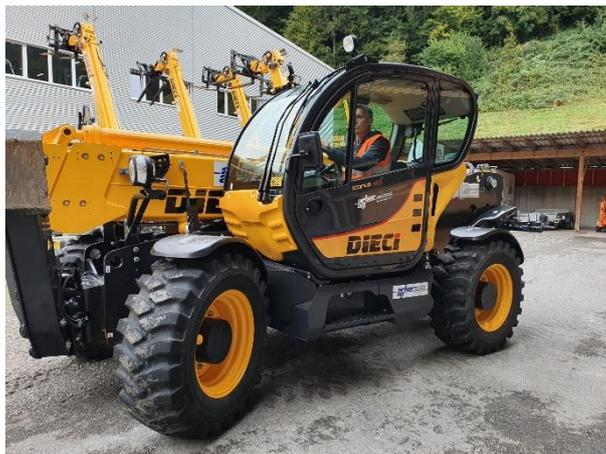
Die Vorderachslenkung bietet Sicherheit bei hoher Geschwindigkeit im Strassenverkehr. Der Drehkranz muss dabei immer blockiert werden.
