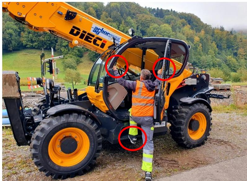
Sich nur an den vorhandenen **Haltegriffen und Trittbrettern festhalten**, nicht am Lenkrad oder anderen Steuervorrichtungen. Niemals von der Maschine abspringen. Haltegriffe und Trittbretter sind sauber zu halten, lose Schrauben sind sofort festzuziehen.
