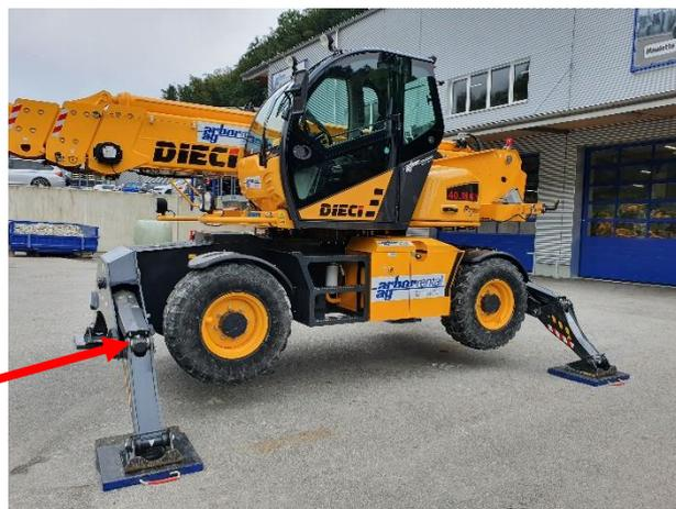
Wenn die Stabilisatoren eingesetzt werden, muss darauf geachtet werden, dass die Räder der Vorderachse komplett ausgehoben sind und die Maschine nivelliert ist. Wird ohne den Einsatz der Stabilisatoren gearbeitet, so müssen die Räder zum Verbessern der Standsicherheit beim Ausfahren des Auslegers gradestehen!
