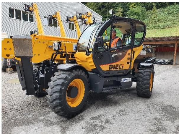
Der Hundegang ermöglicht präzises Manövrieren in engen Fahrwegen.
