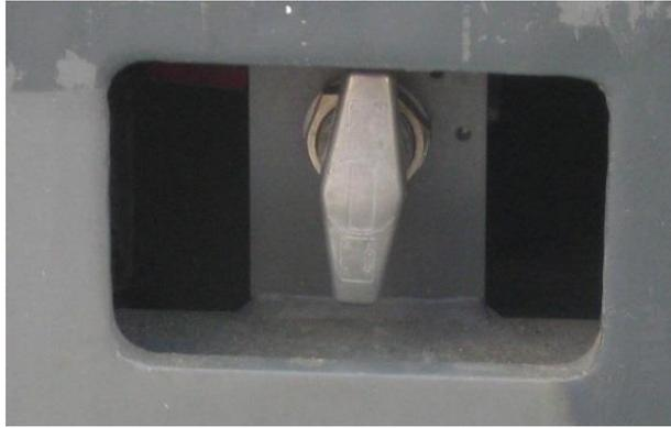
Verfügt der Stapler über einen elektrischen Hauptschalter, so muss mit diesem der Stromkreis unterbrochen werden. Dadurch wird verhindert, dass sich die Batterie entladen kann. Wenn der Stapler in einem Gebäude eingestellt wird, erhöht sich zudem die Brandsicherheit.
