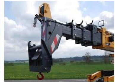
Durch den Anbau eines Hubhakens, gleich welcher Bauweise, wird der Teleskopstapler zu einem Hubgerät (Maschinenrichtlinie 98/37 EG). Der Teleskopstapler mit Hubhaken untersteht ebenfalls der Kranverordnung (Art. 2, Krane Kat. C). Personen, die Lasten an einen Kran anschlagen, müssen für diese Arbeit ausgebildet sein.
