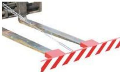
Gabeln müssen hochgeklappt oder mit einem Schutzbalken versehen werden. Den Anhang im Fahrzeugausweis betreffend maximalen vorderen Überhang und weiteren Vorgaben beachten.
