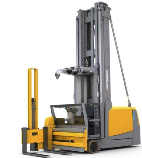
Der Hochregalstapler kommt in Lagerhallen mit hohen Regalen zum Einsatz. Da er hauptsächlich im Schmalgang eingesetzt wird, verfügt er meistens über Führungsrollen auf der Seite. Dank einem speziellen Aufbau der Hubeinrichtung können Lasten seitlich aufgenommen werden, ein Abdrehen im Regalgang ist daher nicht erforderlich. Es gibt zwei Bedienungsarten, entweder vom Fahrersitz aus (man-down) oder über einen Führerstand (man-up), bei dem die Bedienperson ebenfalls angehoben wird.
