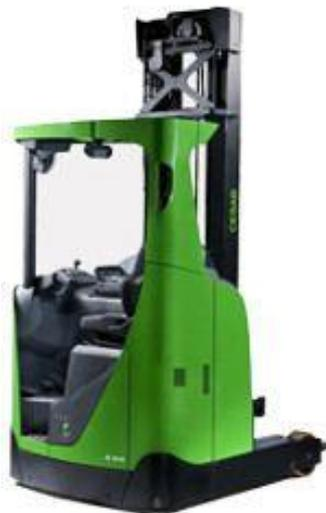
Im Gegensatz zum Quersitzstapler ohne Mastvorschub kann der Schubmaststapler den Mast für den Lastwechsel ca. 60 cm ausfahren. Dadurch wird er vielseitiger einsetzbar. Der Quersitz-Schubmaststapler ist mit eingezogenem Mast radunterstützt, somit wird die Kippgefahr verringert. Es ist deshalb wichtig, dass der Hubmast nur zum Ein- und Auslagern von Lasten ausgefahren wird.
