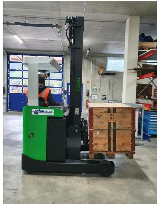
Die Last wird beim Schubmaststapler wann immer möglich hinten geführt. Das hat auch den Vorteil, dass die Lenkung vorne und damit der Drehpunkt des Staplers hinten ist. Dadurch wird das Lenkverhalten des Staplers deutlich weniger aggressiv und das Sichtfeld des Fahrers wird durch die Last nicht eingeschränkt.
