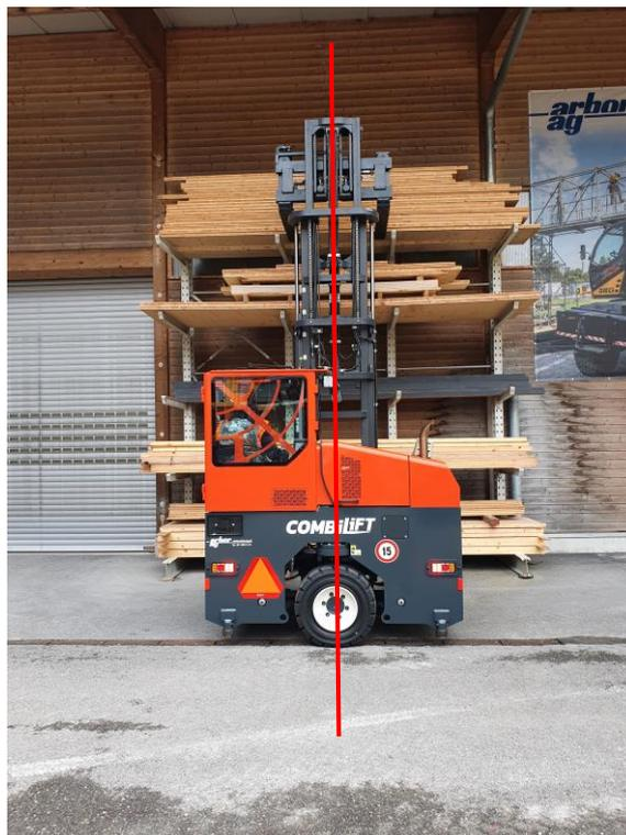
Beim Positionieren oder beim Wegfahren mit der Last vom Regal muss der Boden genau horizontal sein. Eine seitliche Neigung des Staplers durch eine Bodenunebenheit oder eine unkontrollierte Bewegung mit dem Seitenschieber, kann zu einem gefährlichen Verschieben des Schwerpunktes führen!
