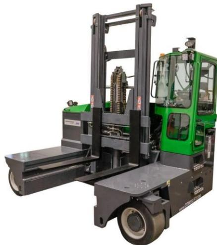
Das besondere Merkmal des Vierwegestaplers ist seine Vielseitigkeit. Die Räder können per Knopfdruck oder mit einem Joystick um 90° gedreht werden. Er kann deshalb in sehr engen Verhältnissen eingesetzt werden. Dadurch, dass Lasten seitlich aufgenommen werden können, ist auch der Umschlag von Langgut möglich. Die Last wird in diesem Fall nicht auf den Gabeln, sondern auf den Radarmen mitgeführt. Vierwegestapler gibt es sowohl als Drei- wie auch als Vierradfahrzeuge.
