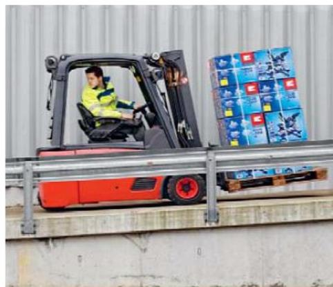
Beim Befahren von Gefällen befindet sich die Last immer auf der Bergseite
