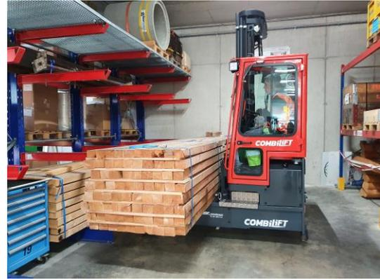
Bei der Aufnahme von Langgut mit dem Vierwegestapler muss darauf geachtet werden, dass die Last symmetrisch auf den Gabeln liegt. Lange Lasten werden auf den Radarmen transportiert.
