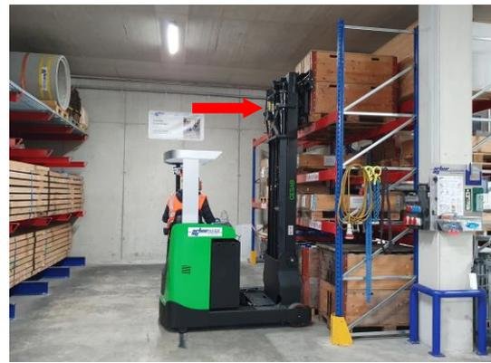
Bis ca. 5 cm an das Regal herantfahren, den Schubmast ausfahren und die Last anheben
