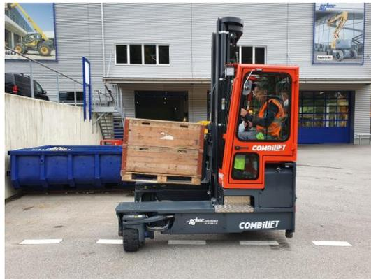
Können Lasten nicht auf den Radarmen abgelegt werden, so müssen diese auf den Gabeln transportiert werden. In diesem Fall ist die Last durch Zurückneigen des Hubmastes (oder der Gabeln) zu sichern.
