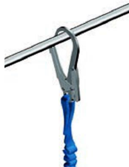
Anschlagpunkt 4 oberer Geländerholm
