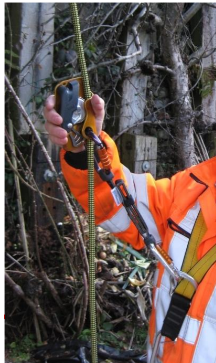
ASAP falsch installiert
