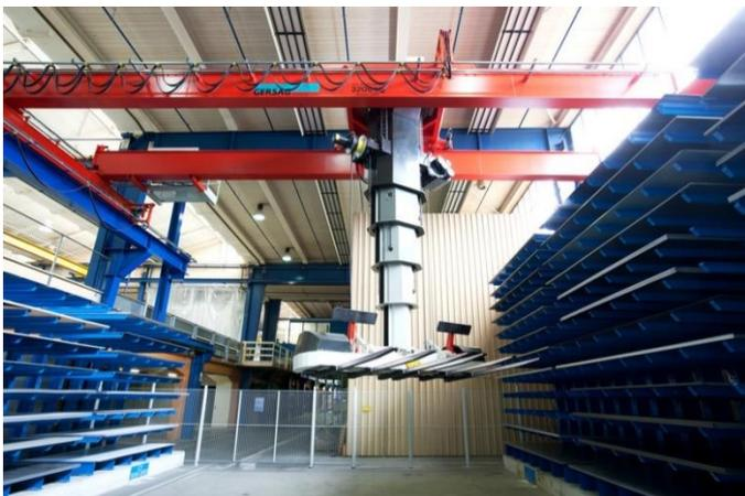
Brückenkran, konstruiert als „Stapelkran“ mit Gabel oder als Vakuumheber
