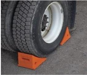
Der Fahrzeugführer (Kranführer) muss beim Verlassen der Kabine die Feststellbremse anziehen. Falls das Fahrzeug in einer Steigung steht, muss das Fahrzeug zusätzlich mit Unterlegkeilen gesichert werden.
