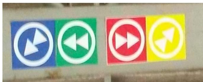
Die Fahrtrichtungen müssen auf der Kranbrücke visualisiert sein und mit jenen der Bedieneinheit übereinstimmen.
