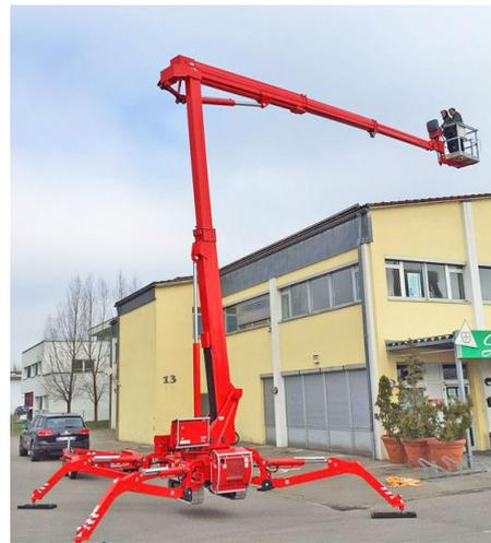
Die Ausführung mit fest auf das Fahrzeugchassis montierter Bühne hat den Vorteil, dass ein Gerät mit grosser Reichweite ohne teuren LKW-Transport für einen Kurzeinsatz vom Bediener mit PW-Ausweis beim Vermieter selber abgeholt werden kann.
