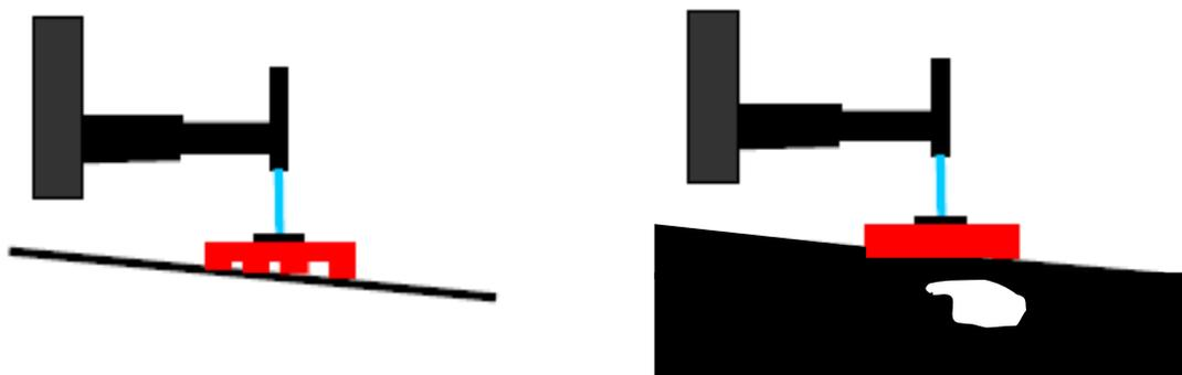
Jede Hubarbeitsbühne hat eine Einrichtung (z.B. Nivellierwaage, Dosenlibelle) die anzeigt, ob die Neigung des Untergestelles in dem vom Hersteller zugelassenen Grenzwert liegt.
